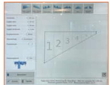
\* Die Touch-Steuerung für die automatische Scharenberechnung.
