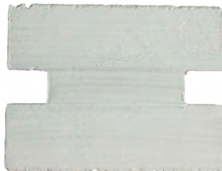
Beispiel eines Prüfkörpers bei der Prüfung der Überstreichbarkeit
