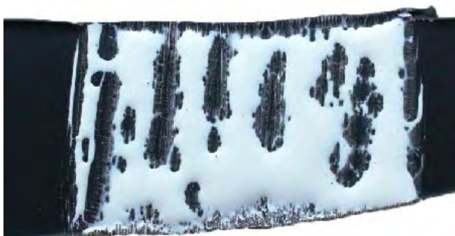
Beispiel einer Verlaufsstörung beim Beschichten eines silikonbasierten Produktes
