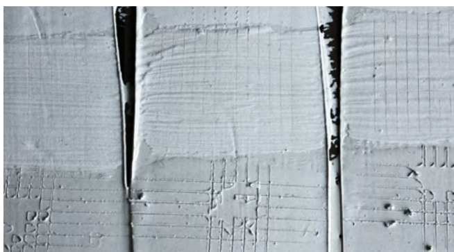
Prüfung der Haftung der Beschichtung auf dem Dichtstoff mittels Gitterschnittprüfung
