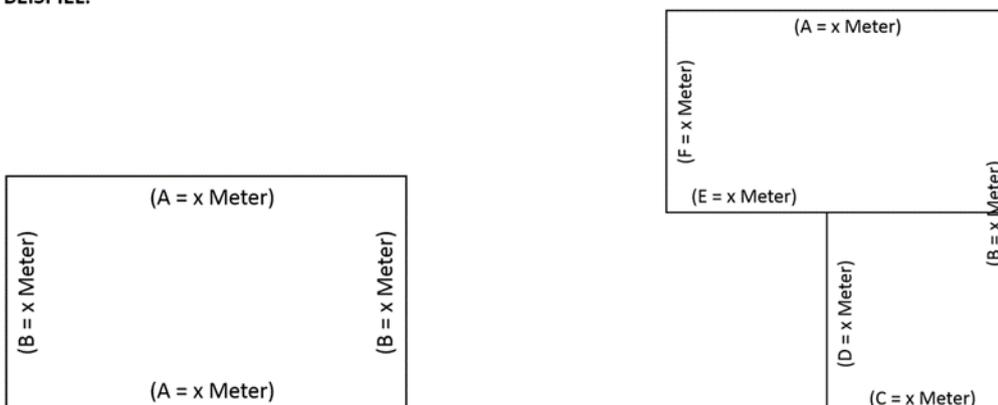
Generell können Anschlüsse ein- oder zweiteilig ausgeführt werden. Wir empfehlen, ab einer Anschlusshöhe von ca. 50 cm zweiteilig zu arbeiten. Dies erleichtert die Arbeitsabläufe.
